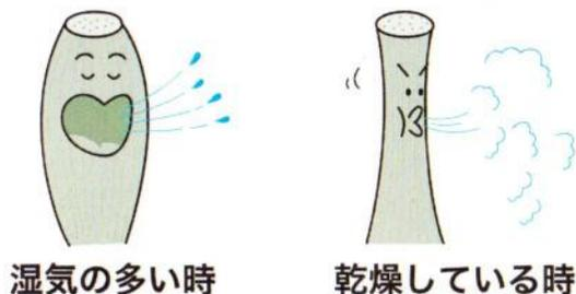
室内の湿度が高い時、湿気を内部のスポンジ状の「なかご」に**吸湿**。また乾燥時には水分を**放出**して**空気中の湿度を一定に調節**します。
